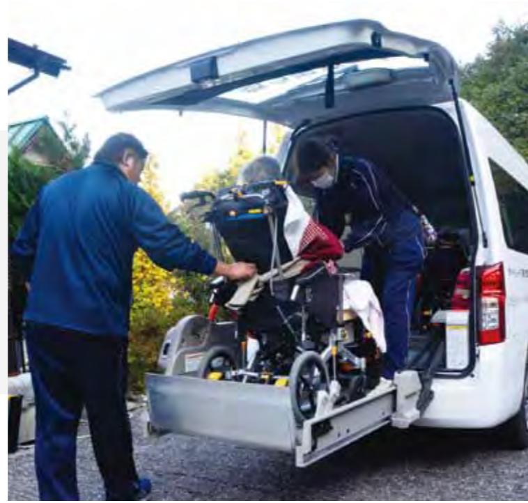
車椅子用リフトは欠かせない装備
