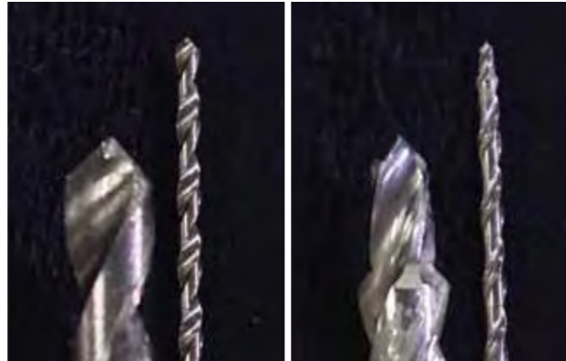
従来品(左)および新開発したドリルの刃(右)の形状比較。 特に刃の先端の形が大きく異なっている
